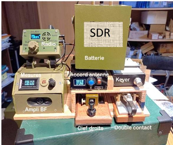
**La SDR ne traite pas un signal numérique mais permet de recevoir une onde radio analogique modulée ou non.** Le microprocesseur remplace tout le traitement du signal perçu par l'antenne comme le faisait la chaîne du superhétérodyne à tubes ou à semi-conducteurs.
