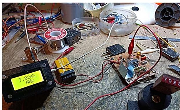
**La forme d'onde obtenue observée à l'oscilloscope n'est pas sinusoïdale mais s'en approche.** Le quartz sélectionne une fréquence précise et élimine ainsi en grande partie les harmoniques. Sans cela, ce type de circuit intégré est destiné au traitement de signaux de forme rectangulaire. L'imperfection du signal n'interfère pas dans l'usage de cette application.
